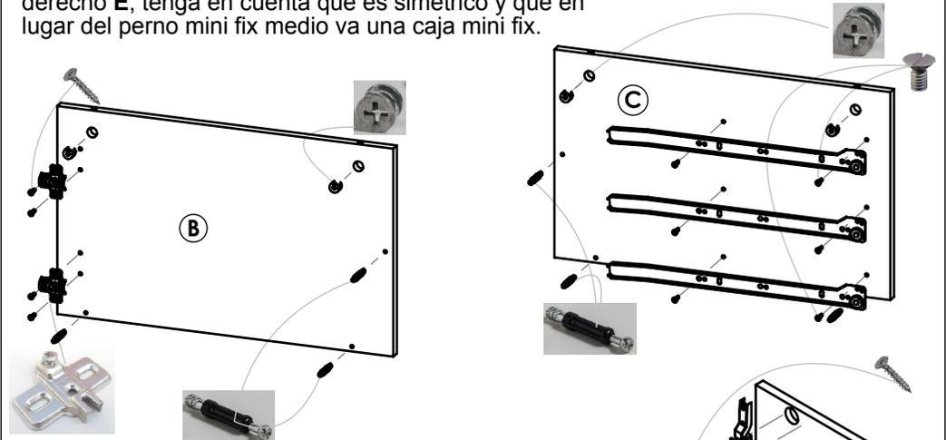
Al costado izquierdo **B**, colocar a presión 2 caja mini fix, atornille 3 pernos mini fix y coloque 2 bases de bisagra mediante los tornillos 3.5x16.
