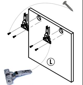
En la puerta **L** coloque 2 bisagra mediante los tornillos 3.5x15.
