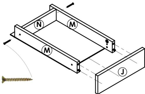
Una vez armada la estructura tipo "U" entre **M-N-M**, agregue adhesivo en los tarugos y haga coincidir las cajas para minifix de los costados con los pernos mini fix del frente de cajón **J**, ajuste las piezas girando media vuelta en sentido horario las cajas mini fix y el fondo con los costados mediante 2 tornillos 4x40.
