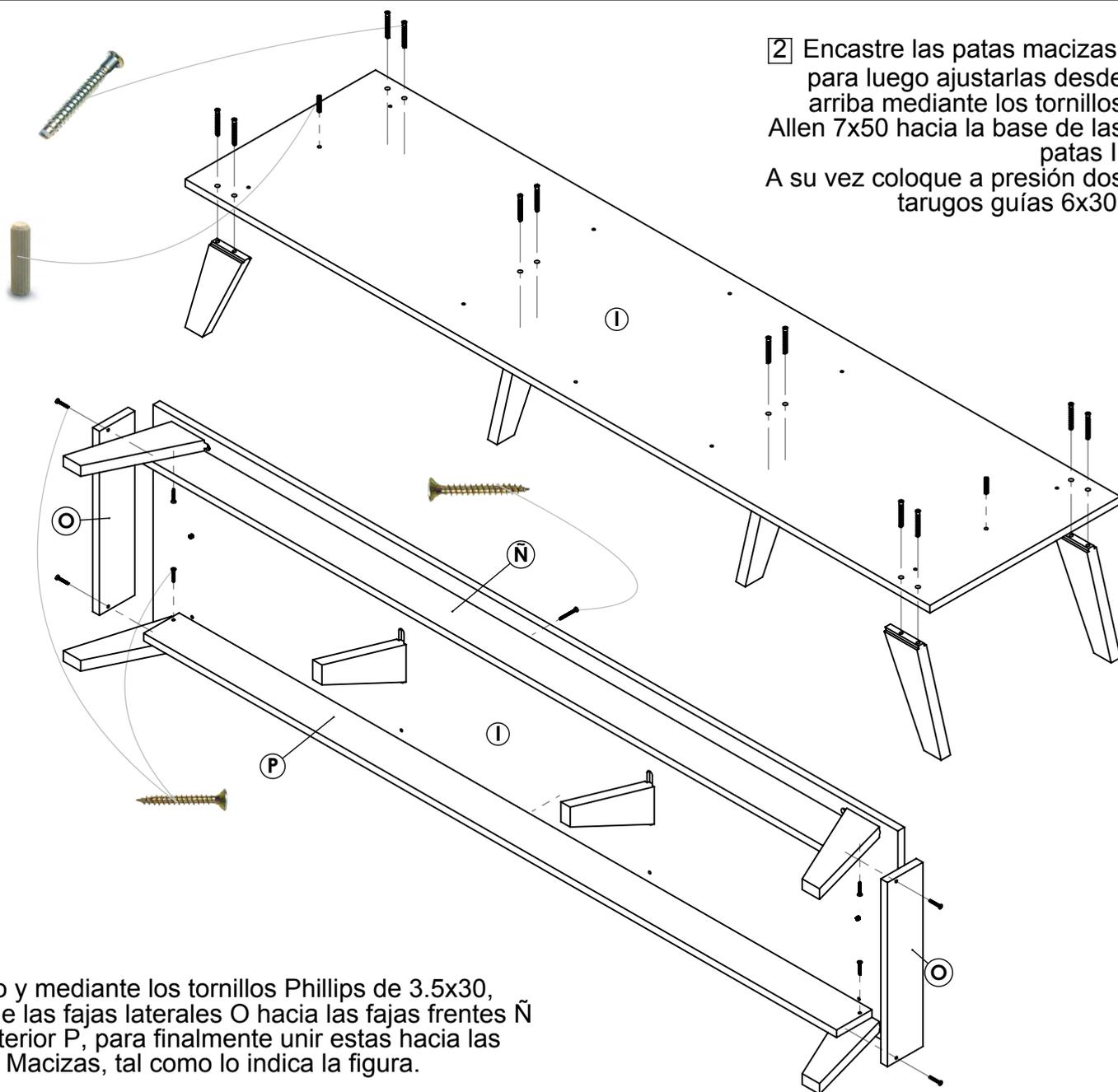
2 Encastre las patas macizas, para luego ajustarlas desde arriba mediante los tornillos Allen 7x50 hacia la base de las patas I. A su vez coloque a presión dos tarugos guías 6x30.
