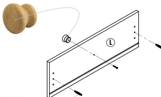
Atornille 3 minifix en el frente de cajón L. Y coloque el tirador con un tornillo de 3,5x30.
