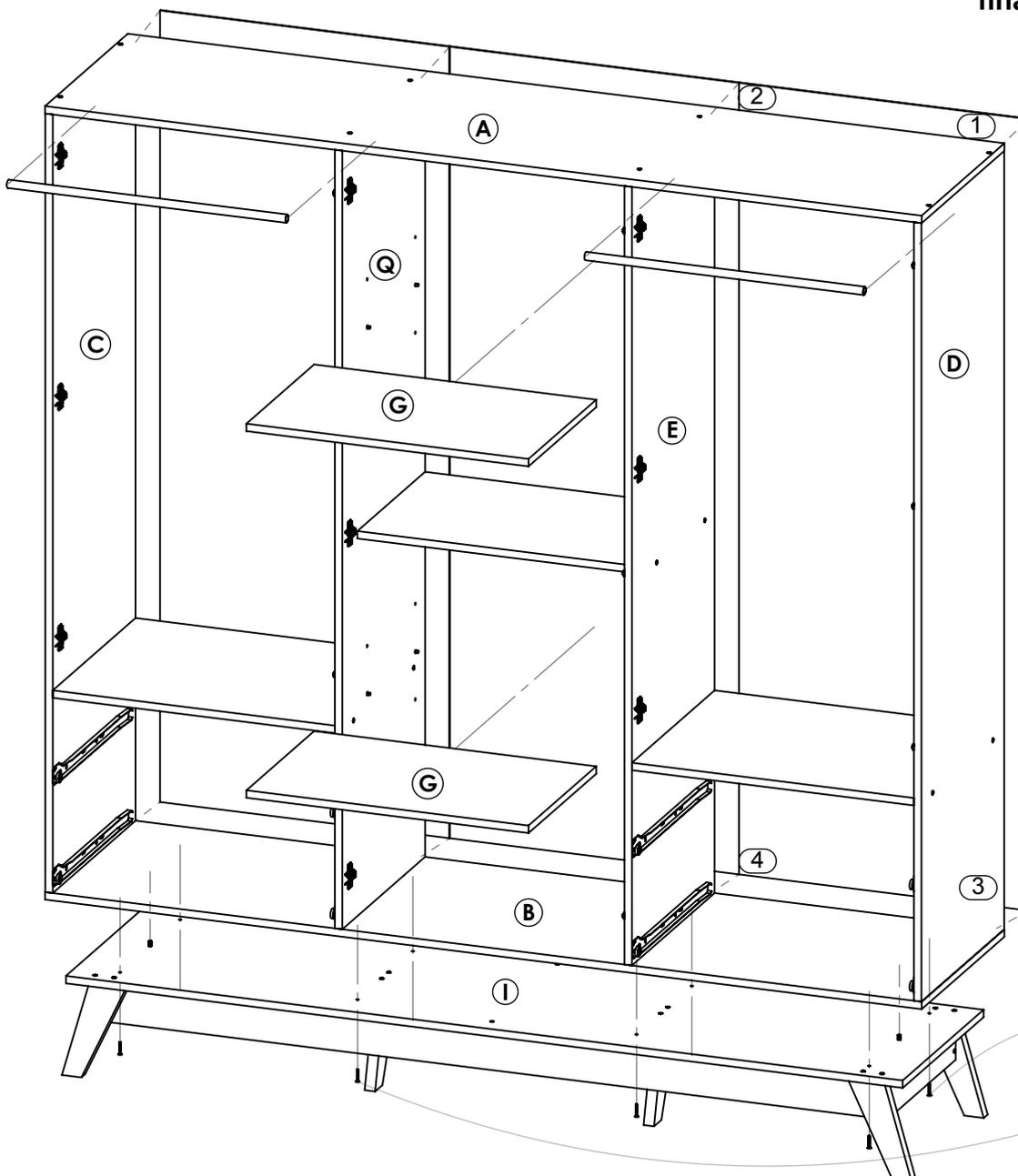
Por último, una vez vertical y ya ubicado, deslice los estantes móviles G sobre los soportes de estantes colocados en el separador izquierdo Q y en el separador derecho E.
