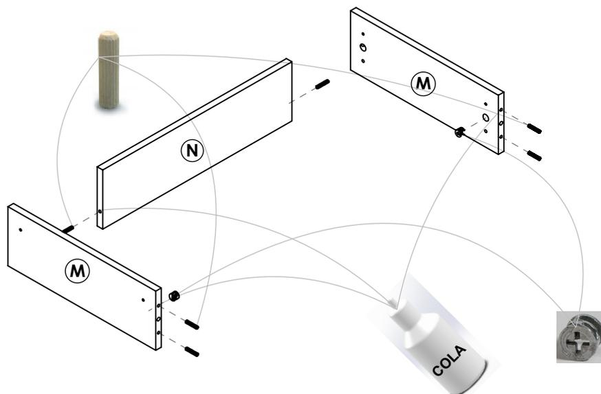
Una vez armada la estructura tipo "U" entre M-N-M, ingrese el frente de cajón L ajuste los pernos mini fix girando 180 grados las cajas mini fix. Habiendo agregado el adhesivo anteriormente. Luego ajuste el fondo y los costados mediante los dos tornillos 4x40.
