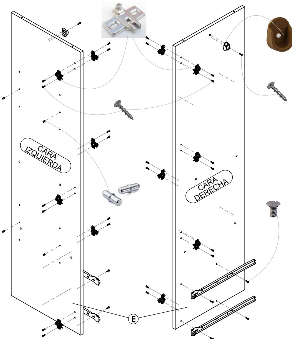
Prepare la cara derecha del separador derecho E, colocando 3 bases de bisagra mediante los tornillos 3.5x15, también el soporte plástico de caño haciéndolo encastrar en la perforación central y luego ajustándolo mediante un tornillo 3,5x15, como lo muestra la figura y atornille las guías metálica fijas izquierdas mediante los tornillos varianta.
