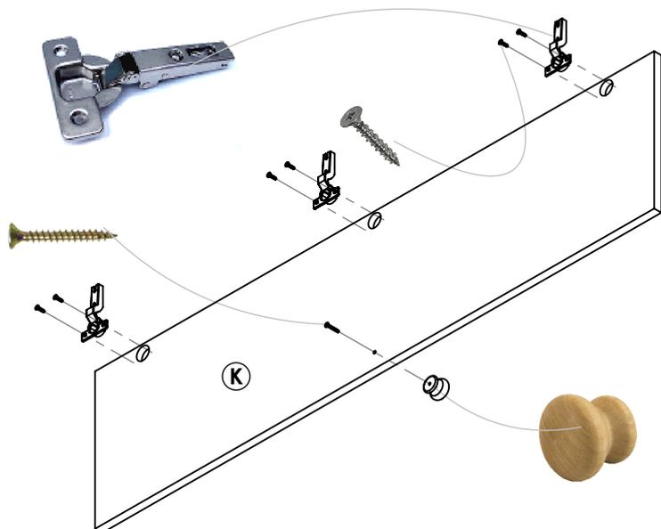
En las puertas cortas K y en las puertas larga J coloque 3 bisagra mediante los tornillos 3.5x15 y un tirador botón mediante un tornillo 3,5x30.
