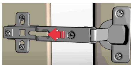
Finalmente ajuste el tornillo de regulación de profundidad.
