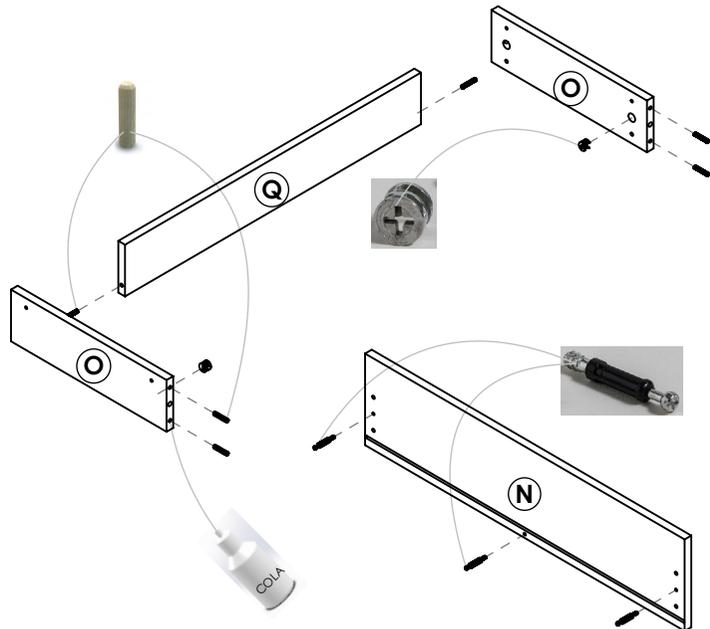
Una vez armada la estructura tipo "U" entre **O-Q-O**, ingrese el frente de cajón **N** ajuste los pernos mini fix girando 180 grados las cajas mini fix.
