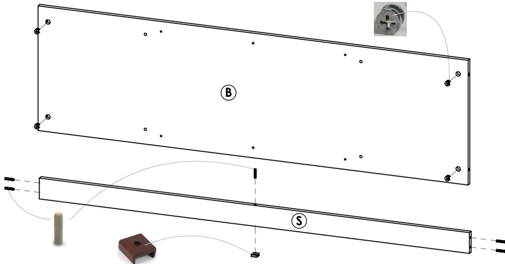
En el piso **B** coloque a presión 4 cajas de mini fix en la cara inferior.
