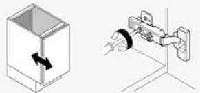
En las placas de montaje sin el ajuste de "cam" afloje los tornillos, ajuste la puerta y aprete los tornillos.
