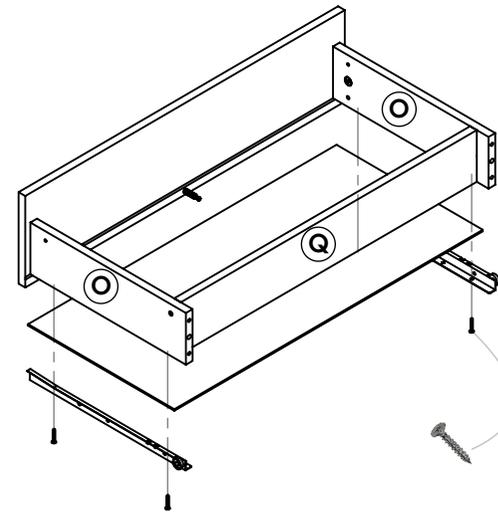
Desde abajo introduzca el piso de cajón sobre el canal del frente de cajón **I**, y clave este siguiendo una escuadra correcta del cajón sobre los filos inferiores de los costados y del fondo.
