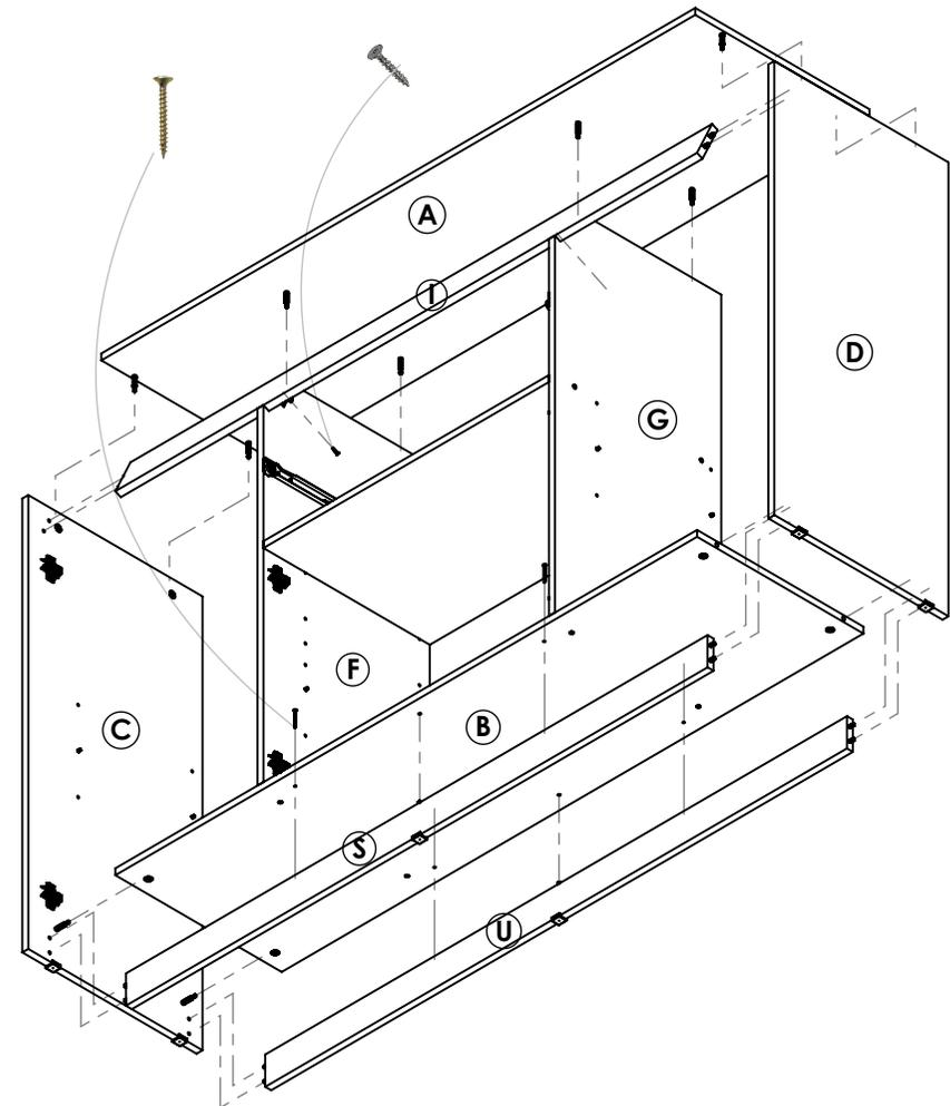
Ajuste desde arriba la tapa **A** haciendo coincidir las perforaciones que se encuentran en los costados y en los separadores, con los pernos mini fix de la misma y posteriormente girando la caja mini fix 180°.
