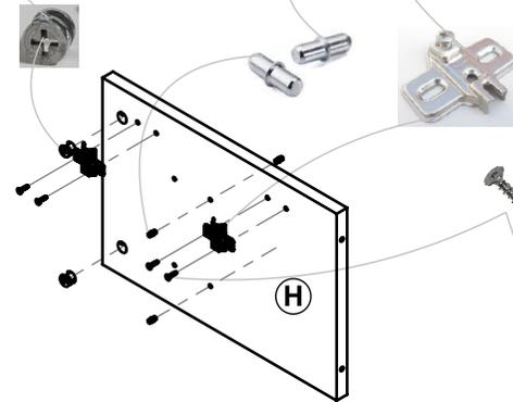
Prepare el separador abajo derecho **H**, colocando a presión 2 cajas mini fix y 4 soportes de estante, 2 en cada cara, además atornille 2 bases para bisagra, mediante los tornillos de 3,5x16. Repita el proceso para el separador izquierdo **G** pero sin colocar bisagras.
