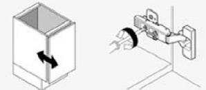
En las placas de montaje sin el ajuste de "cam" afloje los tornillos, ajuste la puerta y aprete los tornillos.
