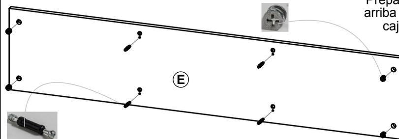
Atornille 8 pernos mini fix en la cara interna de la tapa **A**.
