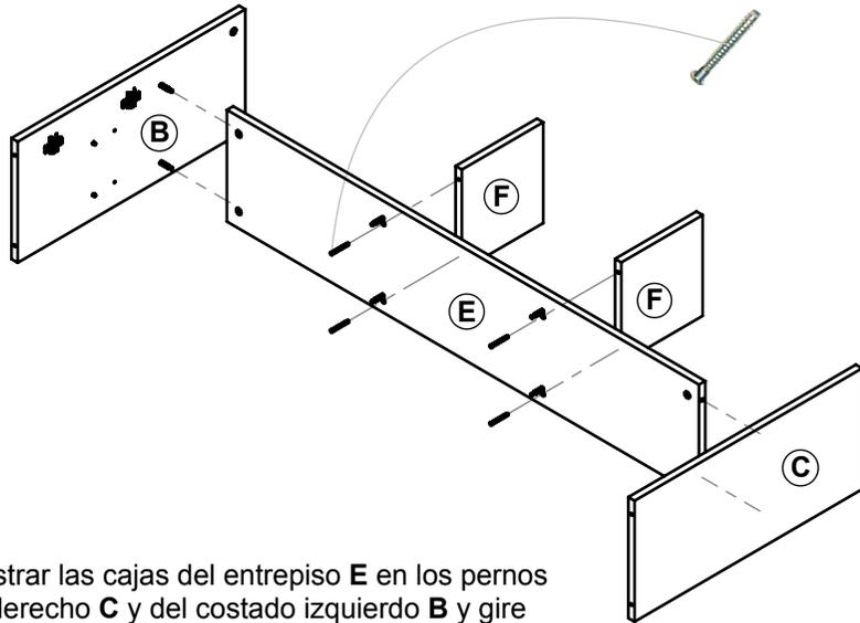
**2** Haga encastrar las cajas del entrepiso **E** en los pernos del costado derecho **C** y del costado izquierdo **B** y gire las caja 180 grados en sentido horario para que las piezas queden fijas. Luego atornillar desde abajo y mediante 4 tornillos Allen 7 x 50 los separadores arriba **F**.
