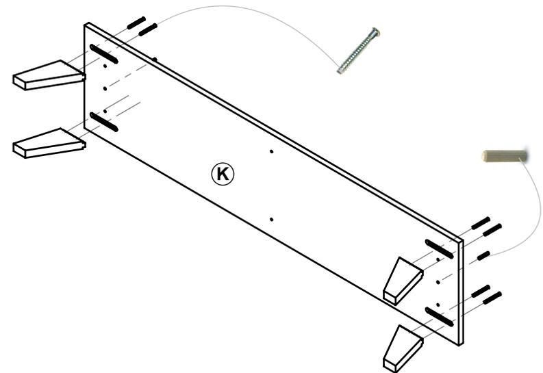
**4** Encastre las patas macizas en la base patas **K**, para luego ajustarlas desde arriba mediante 8 tornillos Allen 7 x 5. Luego coloque a presión 2 tarugos guías 6 x 30.
