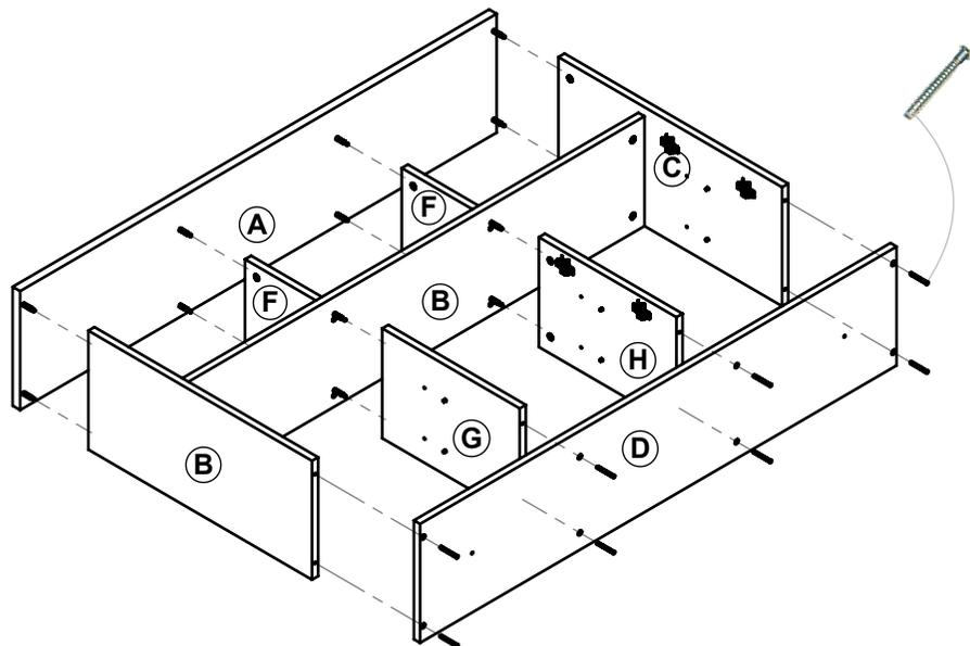
**3** Haga encastrar los pernos de la tapa **A** en las cajas de los laterales **B-C** y de los separador arriba **F** y luego gire las caja 180 grados para que las piezas queden fijas.
