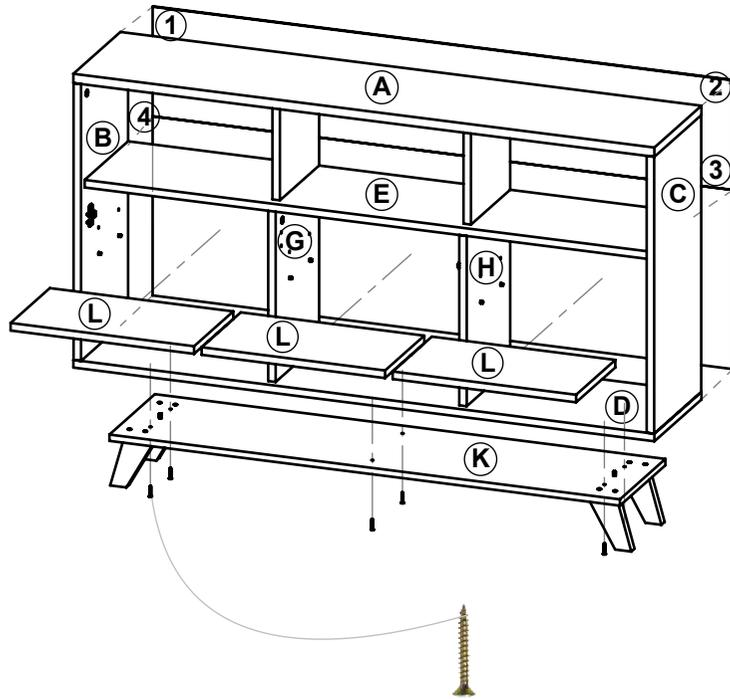
Acto seguido ajuste la base de patas **K** con las patas macizas ya colocadas, al piso **D**, a través de los 6 tornillos Philips de 3,5 x 30 y utilizando como guía las perforaciones donde van los dos tarugos 6 x 30.
