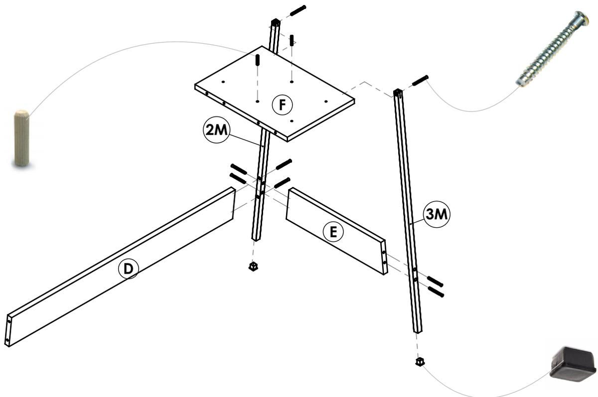
Luego en los extremos inferiores de las patas de caño coloque los regatones.
