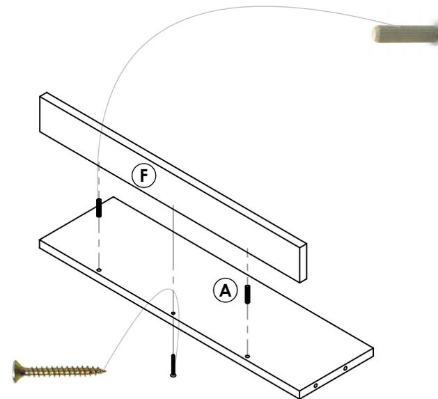
**2** Por medio de los tornillos Phillips de 7 x 50 unir las patas atrás **H** y las patas adelante **I** con el estante uno **A**, el dos **B**, el tres **C** y las fajas **F**.
