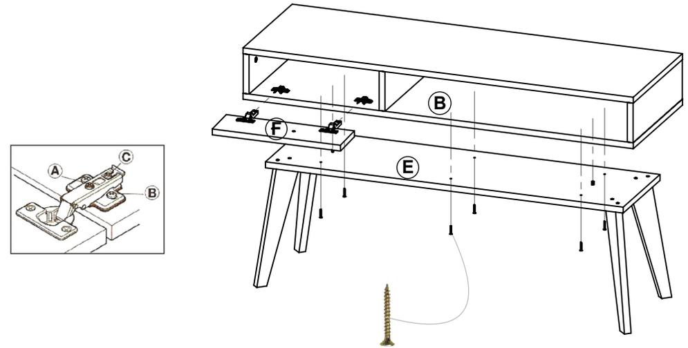
Desde abajo una la base de patas **E** con el piso **B**, a través de los 6 tornillos Philips de 3,5 x 30 y utilizando como guía las perforaciones donde van los dos tarugos 6 x 30.
