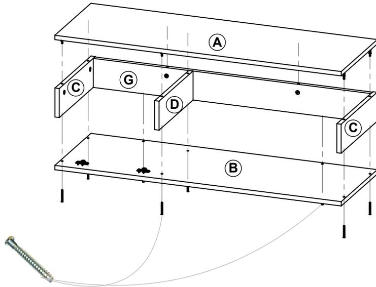
Por ultimo desde abajo ajuste por medio de 8 tornillos Allen 7x50 el Piso **B** a los costados, el separador y la faja refuerzo.
