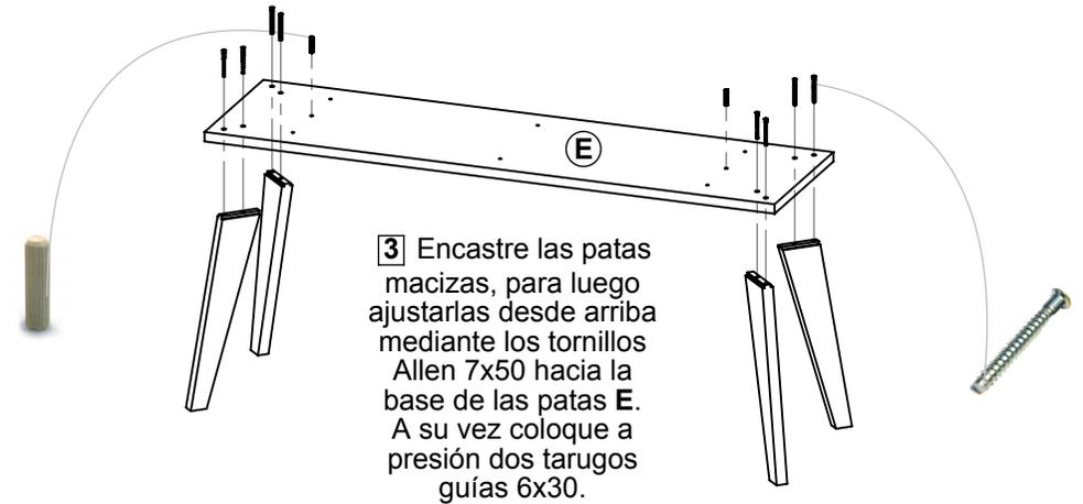
**3** Encastre las patas macizas, para luego ajustarlas desde arriba mediante los tornillos Allen 7x50 hacia la base de las patas **E**. A su vez coloque a presión dos tarugos guías 6x30.
