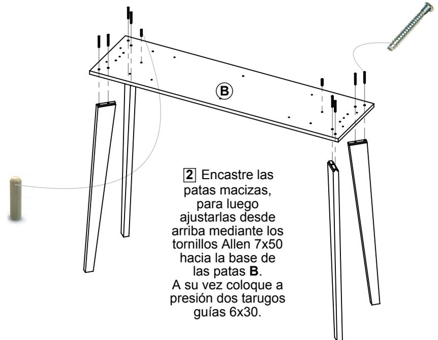
**2** Encastre las patas macizas, para luego ajustarlas desde arriba mediante los tornillos Allen 7x50 hacia la base de las patas **B**. A su vez coloque a presión dos tarugos guías 6x30.
