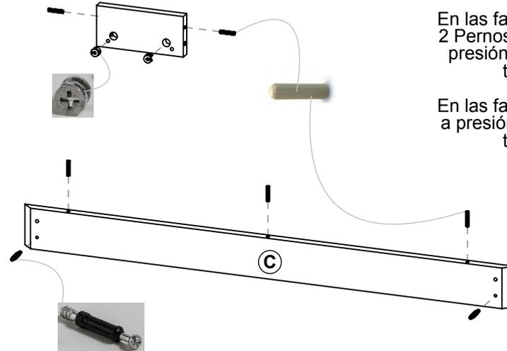
En las fajas largas **C**, atornille 2 Pernos mini fix, y coloque a presión en el filo superior 3 tarugos 6x30.
