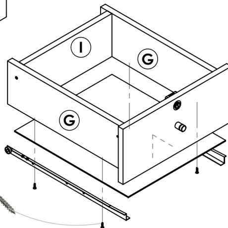
Una vez armada la estructura tipo "U" entre **G-I-G**, ingrese el frente de cajón **F** ajuste los pernos mini fix girando 180 grados las cajas mini fix. Habiendo agregado el adhesivo anteriormente. Luego ajuste el fondo y los costados mediante los dos tornillos 4 x 40.
