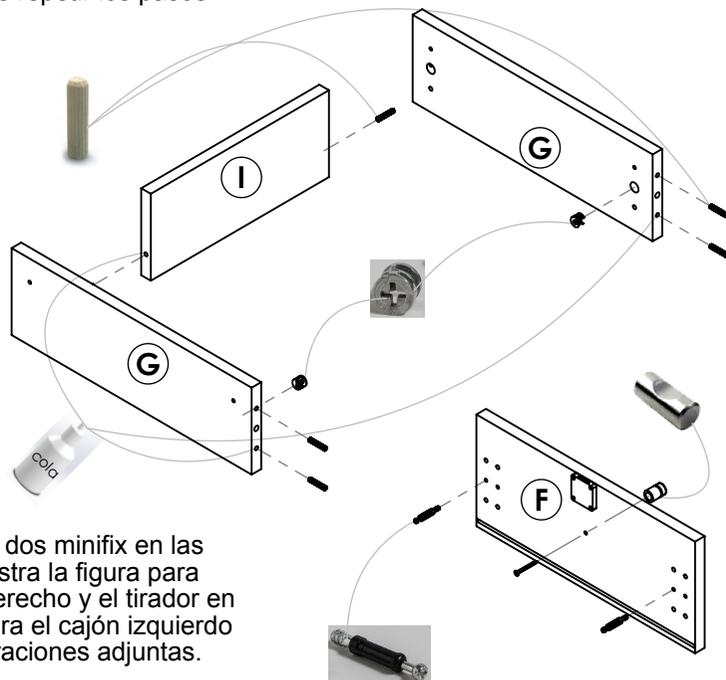
Seguidamente coloque dos minifix en las perforaciones que muestra la figura para poder tener un cajón derecho y el tirador en el frente de cajón **F**. Para el cajón izquierdo colocarlos en las perforaciones adjuntas.
