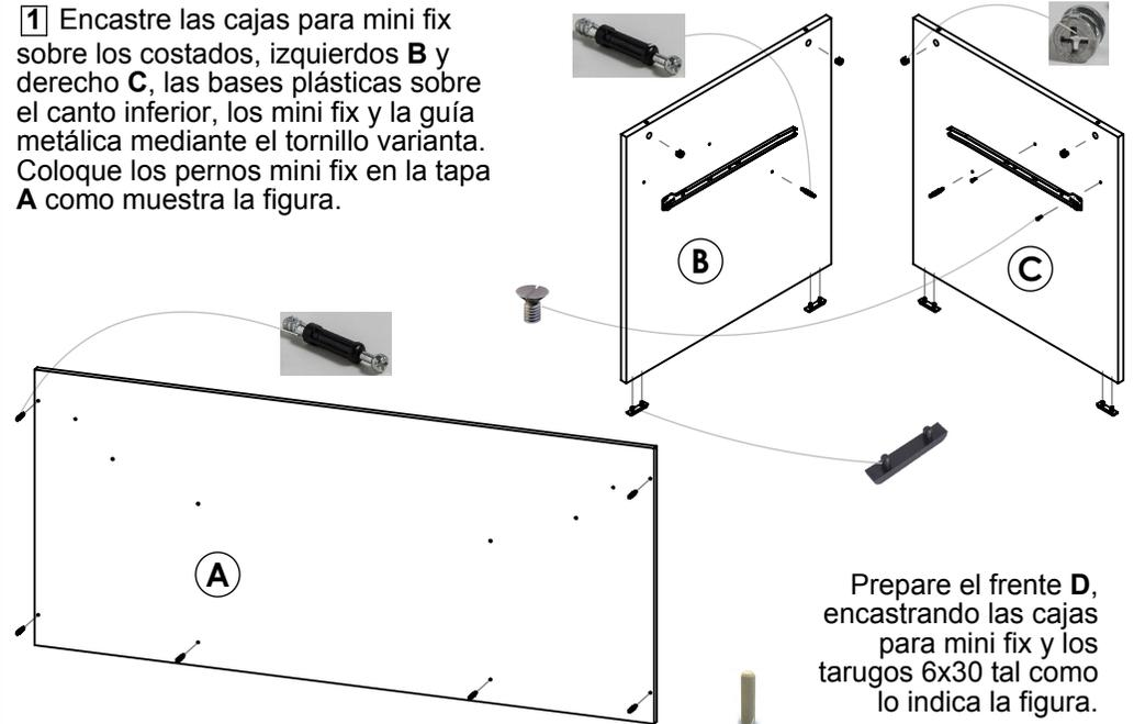
Prepare el frente D, encastrando las cajas para mini fix y los tarugos 6x30 tal como lo indica la figura.
