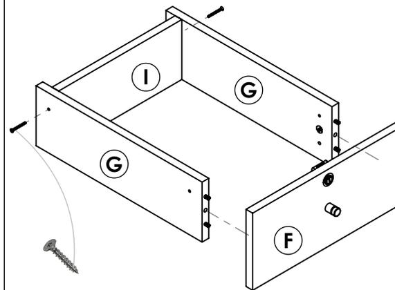
Desde abajo introduzca el piso de cajón sobre el canal del frente de cajón **F**, y clave este siguiendo una escuadra correcta del cajón sobre los filos inferiores de los costados y del fondo. Finalmente atornille las guías metálicas como muestra la figura mediante 4 tornillos 3,5x20.
