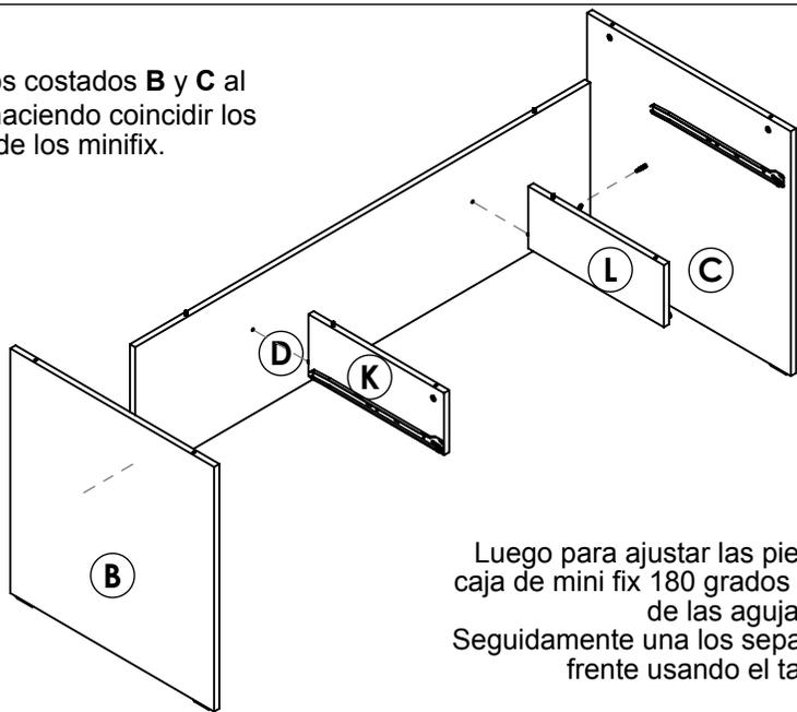
Luego para ajustar las piezas gire la caja de mini fix 180 grados en sentido de las agujas del reloj. Seguidamente una los separadores al frente usando el tarugo guía.
