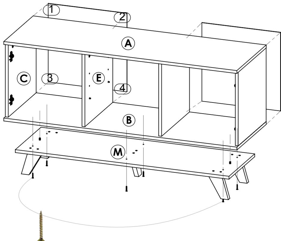
Una vez armado la base de patas M con las patas macizas, ajuste este hacia el piso B, a través de los 6 tornillos de 2,5 cm y utilizando como guía las perforaciones donde van los dos tarugos 6 x 30, **los cuales solo cumplen la función de guía (no golpear).**
