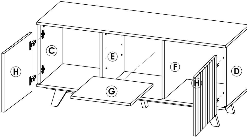
Finalmente deslice el estante móvil G sobre los soportes previamente colocados en los Separadores E-F haciéndolo llegar hasta el fondo.
