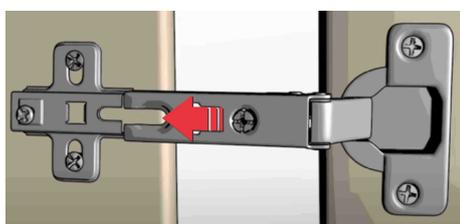
Luego ingrese la bisagra en la base de bisagra haciendo coincidir el tornillo de regulación lateral con la ranura en U de la base.
