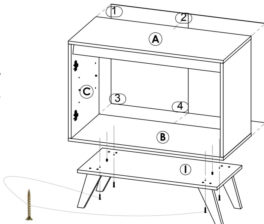
Una vez armado la base de patas I con las patas macizas, ajuste este hacia el piso B, a través de los 4 tornillos de 2,5 cm y utilizando como guía las perforaciones donde van los dos tarugos 6 x 30, **los cuales solo cumplen la función de guía (no golpear).**
