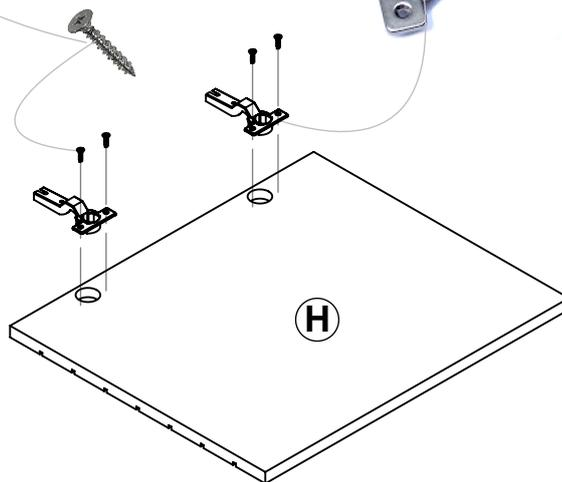
En las puertas H coloque 2 bisagra mediante los tornillos de 1,5 cm.
