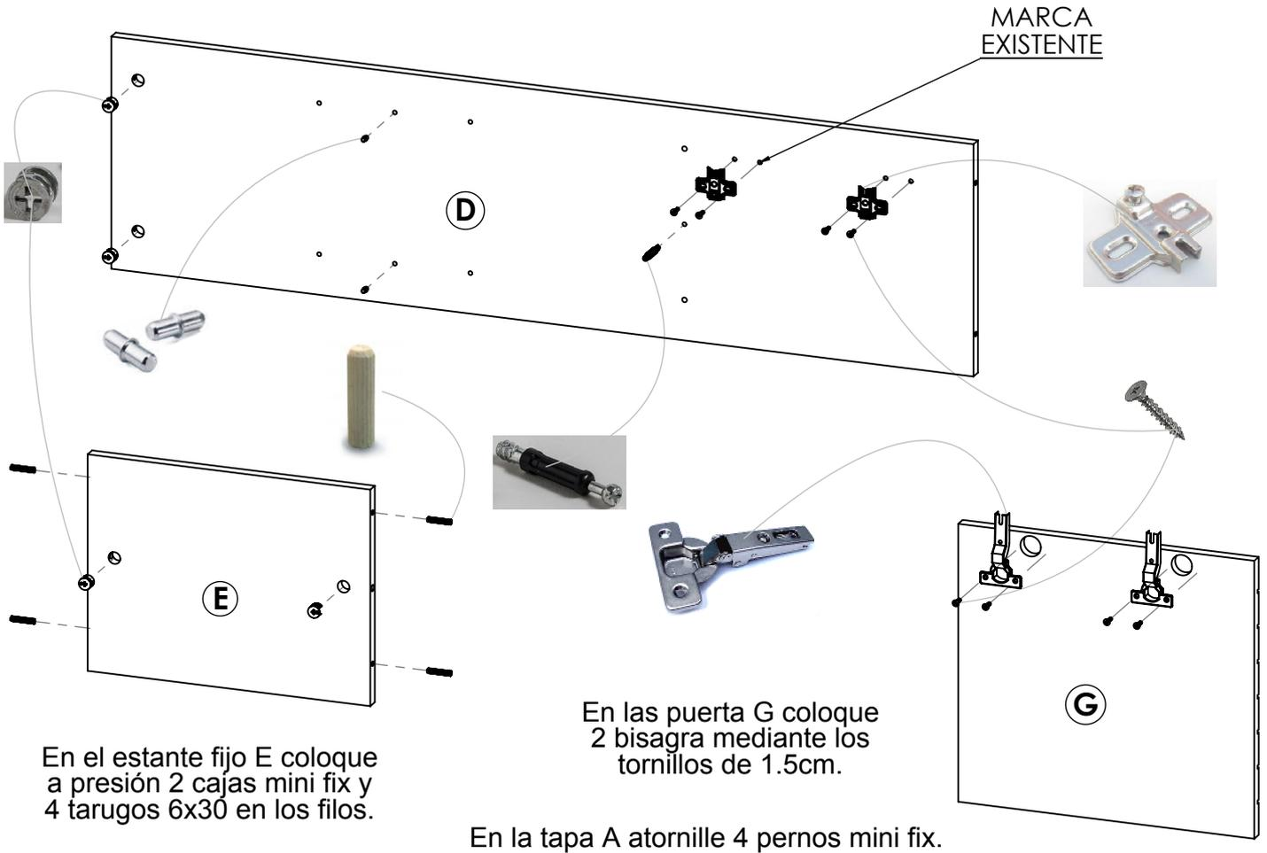
2 Haga encastrar los pernos mini fix que se encuentran en los costados C-D con las perforaciones de las cajas mini fix estante fijo E usando como guía los tarugos guías, y luego para ajustar las piezas gire la caja mini fix media vuelta en sentido horario.
