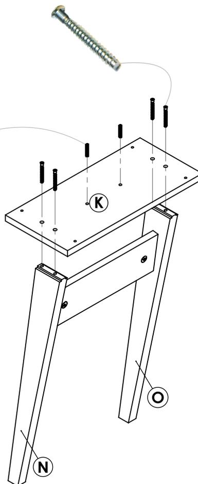
Encastre las patas macizas N-O, para luego ajustarlas desde arriba mediante los tornillos Allen de 5 cm hacia la base de las patas K. A su vez coloque a presión dos tarugos guías 6x30. Repetir el proceso para el otro juego de patas y base de patas.
