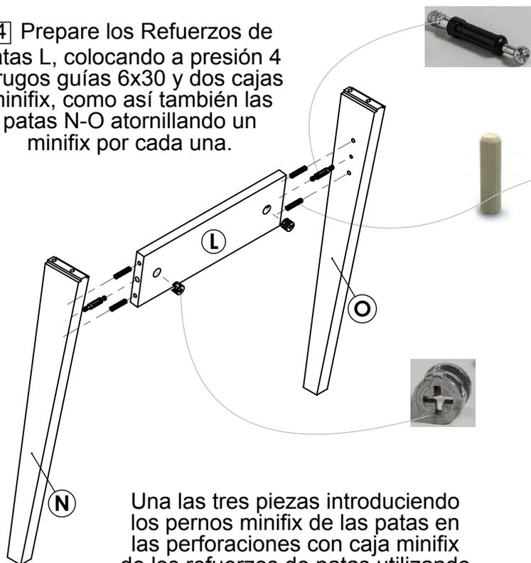
Una las tres piezas introduciendo los pernos minifix de las patas en las perforaciones con caja minifix de los refuerzos de patas utilizando los tarugos como guía, luego ajuste las piezas girando 180 grados en sentido horario las cajas mini fix.
