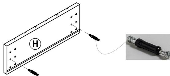
Una vez armada la estructura tipo "U" entre G-I-G, agregue adhesivo en los tarugos y haga coincidir las cajas para minifix de los costados con los pernos mini fix del frente de cajón H, ajuste las piezas girando media vuelta en sentido horario las cajas mini fix y el fondo con los costados mediante 2 tornillos de 4 cm.
