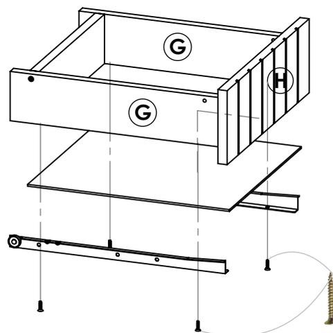
Finalmente ingrese el piso de cajón en el canal del frente de cajón y clávelo desde abajo a los costados y el fondo. Atornille las guías metálicas sobre los cantos inferiores de los costados de cajón G, mediante 4 tornillos de 2 cm.
