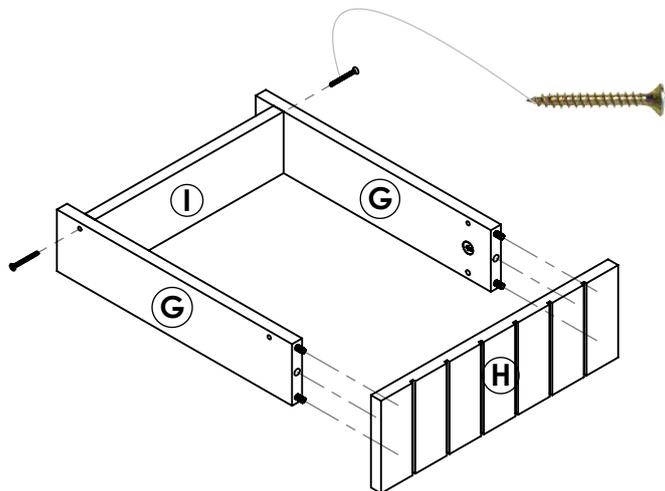
En el frente de cajón atornille dos pernos mini fix en las perforación que indica la figura para que sea derecho. Si lo requiere izquierdo atornille los pernos en la perforación adyacente.
