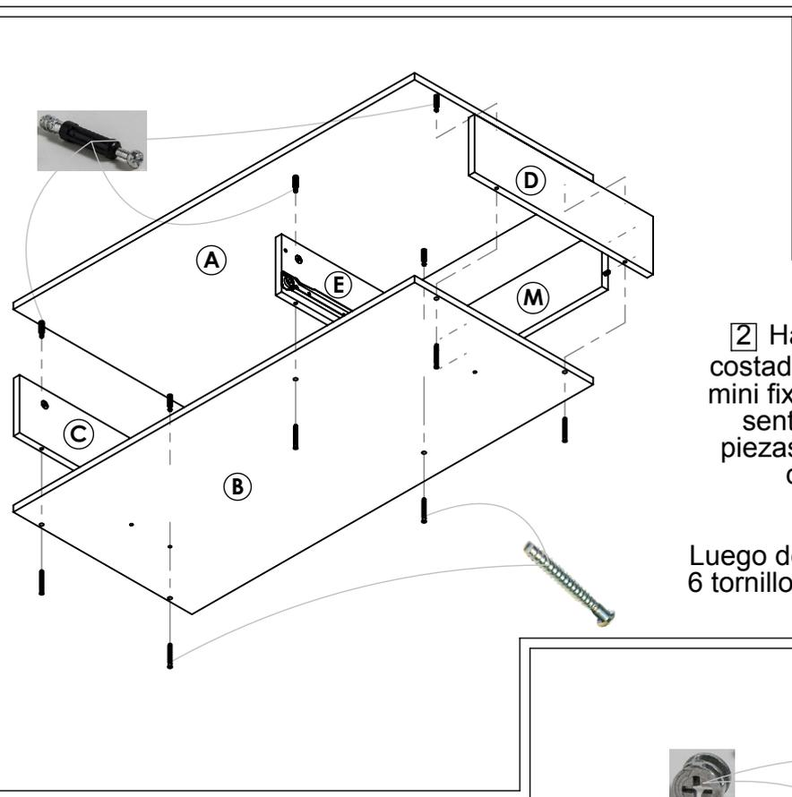
**2** Haga coincidir las cajas para minifix de los costados C-D y del separador E con los pernos mini fix de la tapa A, luego gire media vuelta en sentido horario las cajas, para ajustar dichas piezas, previamente haga coincidir los tarugos del fondo M con las perforación libres del costado derecho y del separador.
