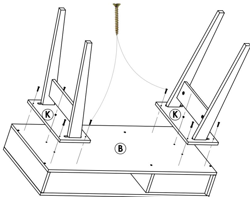
5 Una vez armado las bases de patas K con las patas macizas, ajuste estas hacia el piso B, a través de los 8 tornillos de 2,5 cm y utilizando como guía las perforaciones del piso donde van los tarugos 6x30 colocados en las bases (los cuales solo sirven de guía no golpear!).
