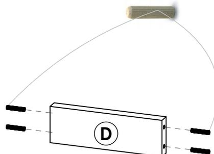
Haga coincidir los tarugos de los travesaños D con las perforaciones de las patas E, inmediatamente vincule los estantes A con las patas mediante los tornillos Phillips de 5 cm.
