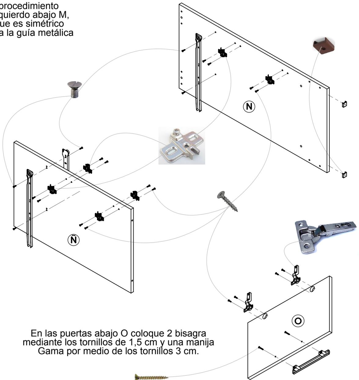
En las puertas abajo O coloque 2 bisagra mediante los tornillos de 1,5 cm y una manija Gama por medio de los tornillos 3 cm.
