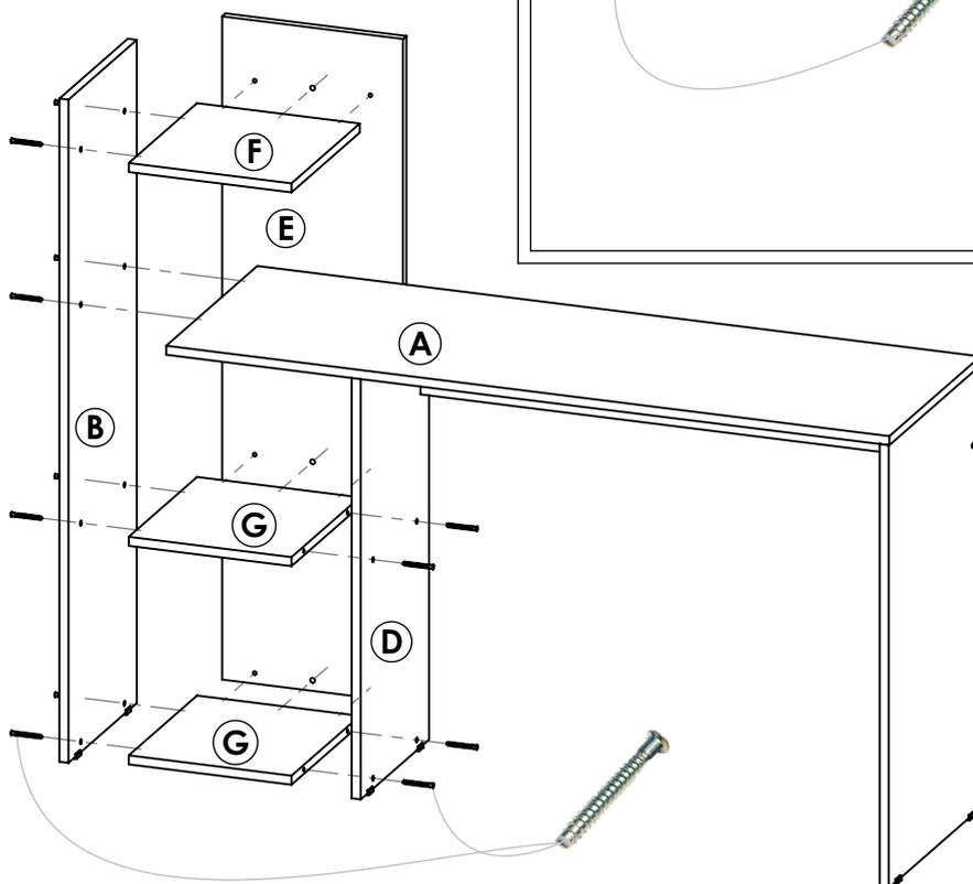
3 Una el separador D con los estantes abajo G y el costado izquierdo B mediante 4 tornillos Phillips de 5 cm. A su vez una la tapa A con el costado izquierdo este a el estante arriba por medio de 4 tornillos.
