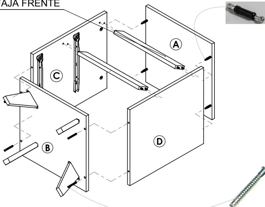
3 Una la tapa A a los costados C - D, introduciendo los pernos minifix de la tapa en las perforaciones de las cajas minifix de los costados, previamente haga coincidir los tarugos de las fajas frente, con las perforaciones de los costados. Luego ajuste las piezas girando 180 grados en sentido horario las cajas mini fix.
