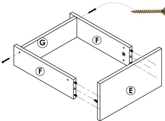
Una vez armada la estructura tipo "U" entre F-G-F, ingrese el frente de cajón E ajuste los pernos mini fix girando 180 grados las cajas mini fix. Habiendo agregado el adhesivo anteriormente. Luego ajuste el fondo y los costados mediante los dos tornillos 4 cm.
