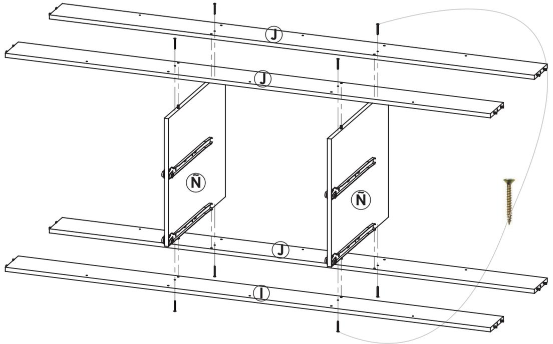
3 Una el costado derecho abajo N con las tapas y piso abajo I - J por medio de los tornillos Phillips de 5 cm, previamente haciendo coincidir los tarugos de la tapa piso abajo en las perforaciones en los costados.
