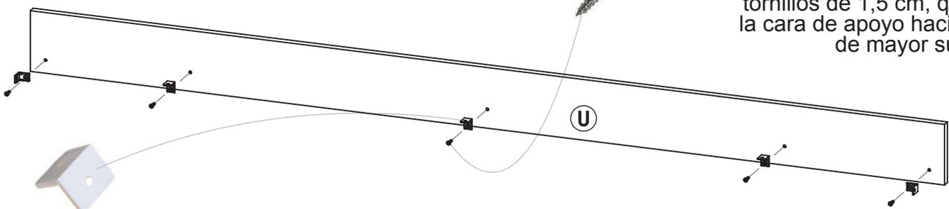
En la puerta centro T coloque a presión una manija Atenas y en la cara con las marcas por medio de 6 tornillos de 1,5 cm atornille los dos carros colgantes delanteros (mayor pliegue).
