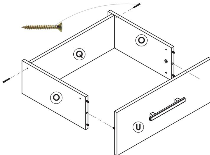
Desde abajo introduzca el piso de cajón sobre el canal del frente de cajón U, y clave este siguiendo una escuadra correcta del cajón sobre los filos inferiores de los costados y del fondo.
