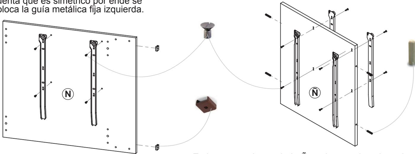
En los separadores abajo Ñ, en la cara derecha colocar dos guías metálicas fijas izquierda partiendo de la primer perforación mediante los tornillos variante, con los mismos tornillos colocar en la cara izquierda dos guías metálicas fijas derecha como lo muestra la figura.
