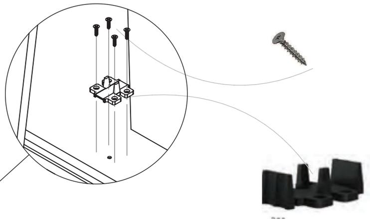
10 Una vez colocada las puertas traseras coloque la guía del piso central por medio de de cuatro tornillos de 1,5 cm en el piso arriba A, usando como guía la imagen en la pagina 10.
