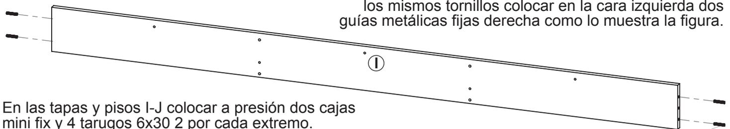
En las tapas y pisos I-J colocar a presión dos cajas mini fix y 4 tarugos 6x30 2 por cada extremo.
