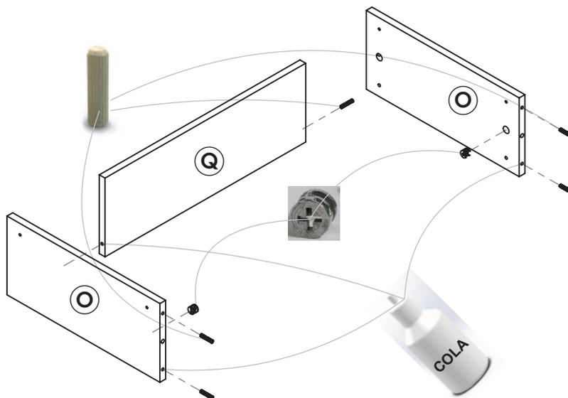
Una vez armada la estructura tipo "U" entre O-Q-O, ingrese el frente de cajón T ajuste los pernos mini fix girando 180 grados las cajas mini fix. Habiendo agregado el adhesivo anteriormente. Luego ajuste el fondo y los costados mediante los dos tornillos 4 cm.
