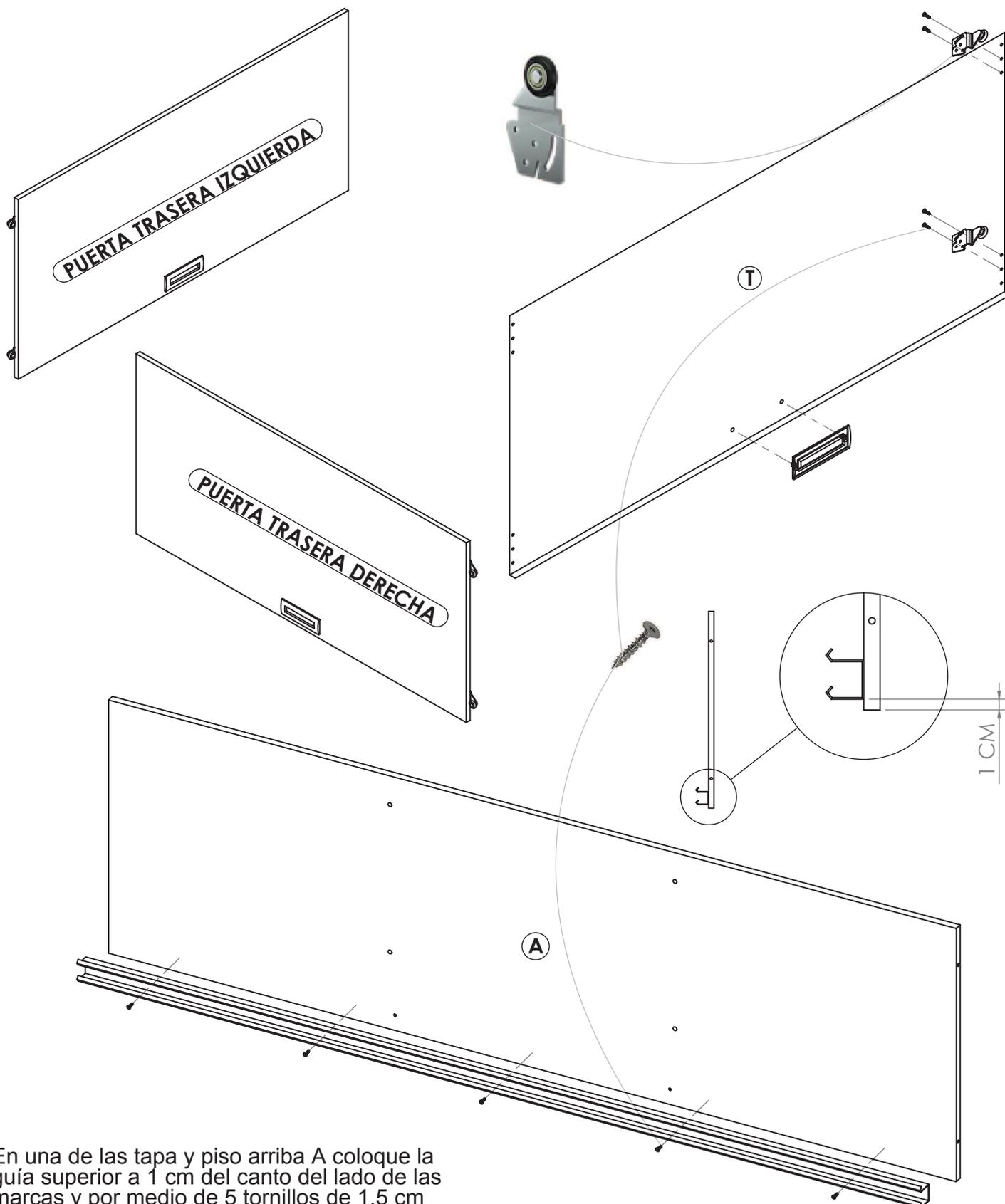
En una de las tapa y piso arriba A coloque la guía superior a 1 cm del canto del lado de las marcas y por medio de 5 tornillos de 1,5 cm atornillela.
