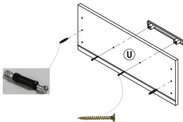
Atornille 2 minifix en el frente de cajón U. Y coloque la manija gama con 2 tornillo de 3 cm.
