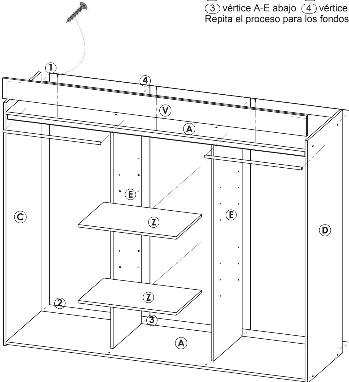
Luego alinee la faja arriba V con los bordes superiores de los costados C-D y seguidamente atornille la misma por medio de 5 tornillos de 1,5 cm aferrando la faja por medio de las 5 escuadras plásticas 2 con los costados arriba y 3 con la tapa.
