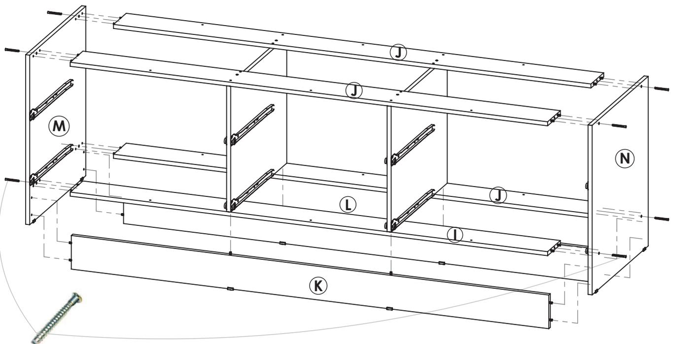
4 Ajuste los zócalos al piso mediante 6 tornillos 4 cm introduciendo estos en las perforaciones libre de los pisos abajo como lo muestra la figura.
